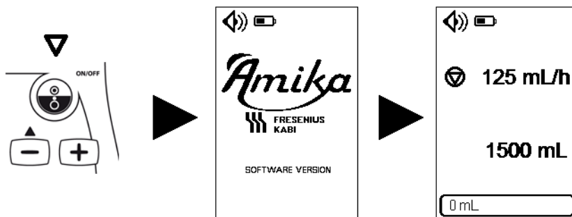
Abbildung 3: Selbsttest der Ernährungspumpe
